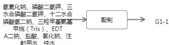
图 3-1 缓冲液配置工艺流程及产污节点图
