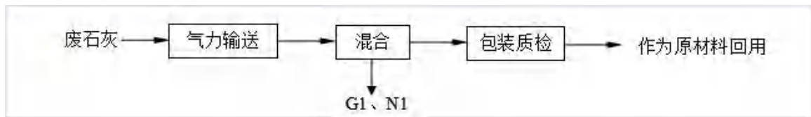
图 3-1 废石灰减量化工艺流程及产污环节图
