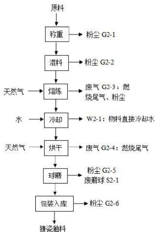
图 2-2 搪瓷釉料生产工艺流程及产污节点图
